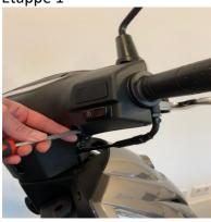
Démontez les rétroviseurs et dévissez les vis du carénage arrière du guidon.
