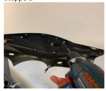
Utilisez une perceuse de 9,5 mm pour percer les quatre repères du cache guidon. Procédez avec prudence.
