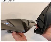
Placez les quatre embbouts du saute vent dans les quatre trous du cache guidon. Fixez le saute vent sur le cache guidon avec les vis parker (5 x 16).
