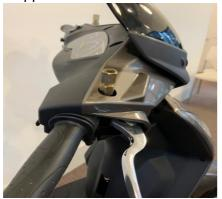
Montez d'abord les vis de fixation des rétroviseurs et introduisez ensuite les rétroviseurs dans leurs emplacements. Vérifiez la fixation des rétroviseurs.
